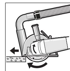
Включите электроинструмент и приставьте переднюю часть направляющих салазок к обрабатывающей заготовке. Ведите пневматический инструмент с равномерной, рассчитанной на обрабатываемый материал подачей. При обработке особо
