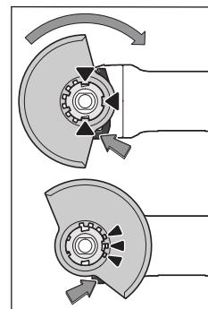
Положите защитный кожух (8) на крепление на электроинструменте так, чтобы кодирующие кулачки защитного кожуха соответствовали креплению. При этом нажмите и держите нажатым рычаг разблокировки (1). Надавливая на защитный кожух (8), наденьте его на шейку шпинделя так, чтобы буртик защитного кожуха сел на фланец электроинструмента, и поворачивайте защитный кожух, пока он не войдет отчетливо в зацепление.
